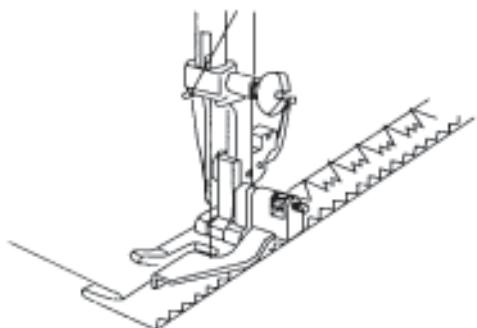
Опустите прижимную лапку. Отверткой ослабьте винт адаптера и вставьте лапку для потайного шва. Затяните винт и поднимите прижимную лапку.
